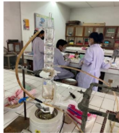
Gambar 1 Rangkaian Metode Sokletasi
