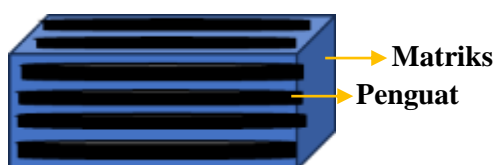
Gambar 1. Susunan penguat dan matriks dalam bahan komposit (Sumber: Akay, 2015)
