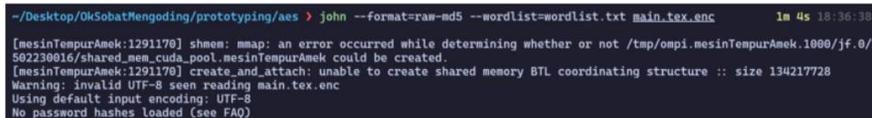
**Gambar 2** Melakukan uji coba penetrasi file yang terenkripsi menggunakan *JohnTheRipper*
