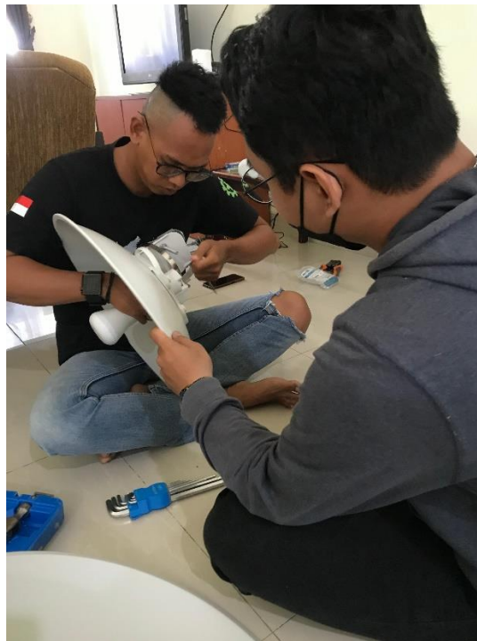
Gambar 11. Pemasangan Cambium Antena
