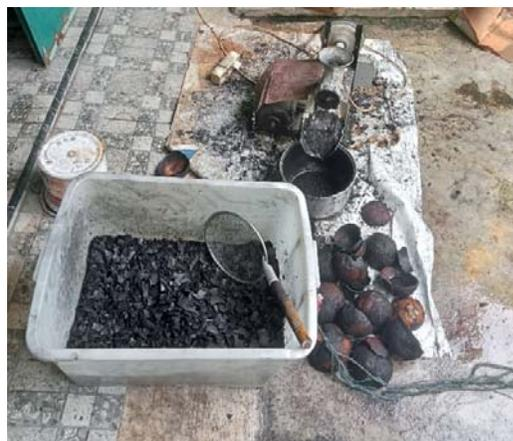
Setelah dijemur, batok kelapa yang telah menjadi arang kemudian dihaluskan menggunakan mesin penghalus. Proses penghalusan ini bertujuan untuk mendapatkan ukuran partikel arang yang seragam. Ukuran partikel yang seragam sangat penting dalam pembuatan briket, karena akan mempengaruhi kepadatan dan kualitas briket yang dihasilkan. Mesin penghalus akan memudahkan proses ini, sehingga arang dapat dihaluskan dengan lebih cepat dan efisien.
