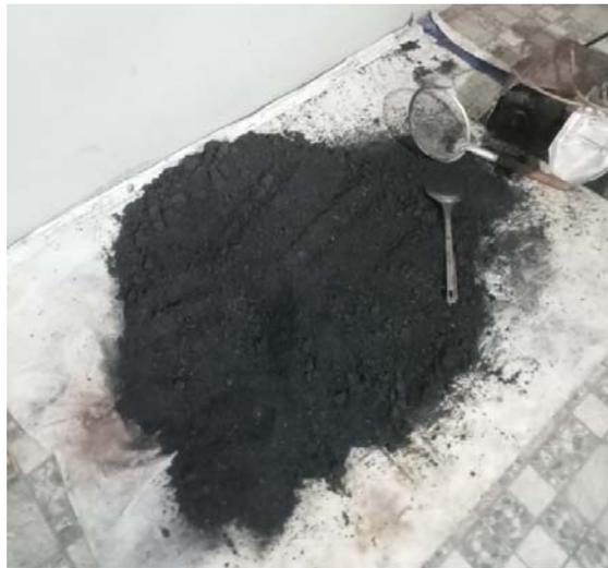
Setelah proses penggongsengan, arang yang telah halus dijemur kembali selama satu malam. Penjemuran ini bertujuan untuk menghilangkan uap panas dan kelembapan yang masih ada pada arang. Proses pengeringan yang baik sangat penting untuk memastikan bahwa arang yang dihasilkan memiliki kadar air yang rendah. Kadar air yang tinggi dapat mempengaruhi kualitas briket, sehingga perlu dilakukan penjemuran yang cukup lama.
