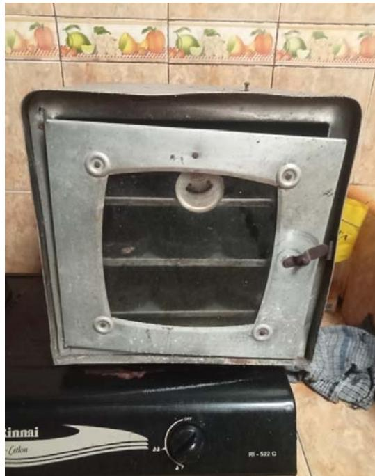
Proses terakhir dalam pembuatan arang briket adalah pengeringan. Briket yang telah dicetak kemudian dimasukkan ke dalam oven untuk dikeringkan selama delapan jam. Pengeringan ini bertujuan untuk menghilangkan kadar air yang masih ada dalam briket,
