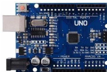
**Gambar 2. 4 Mikrokontroler Arduino Uno**
