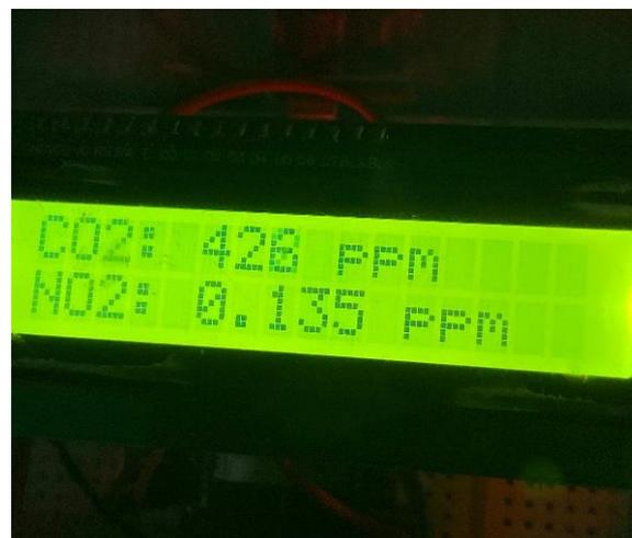
**Gambar 4. 3 Tampilan Monitor LCD sebagai Receiver**
