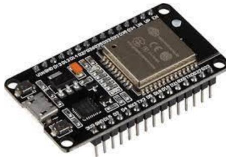
**Gambar 2. 3 Mikrokontroler ESP32**
