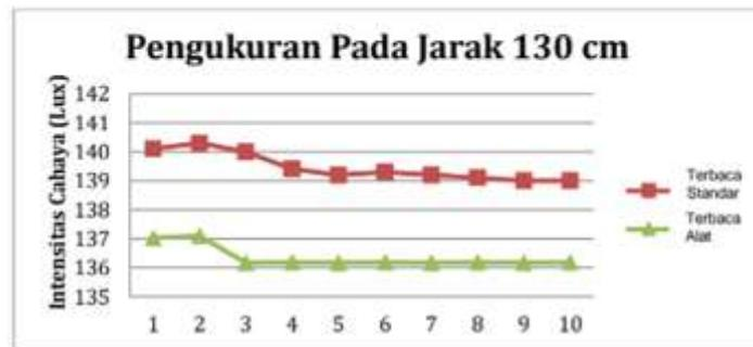
Data yang diperoleh dengan sumber cahaya kolimator yang sama dan posisi Lux Meter standar yang sama dengan posisi alat (jarak 130 cm dari sumber cahaya), terdapat selisih antara hasil pengukuran Lux Meter Standar dengan alat. Selisih pengukuran hasil pengujian yang dilakukan diperoleh nilai persentase error sebesar 0,022 % dan simpangan sebesar -3 Lux.
