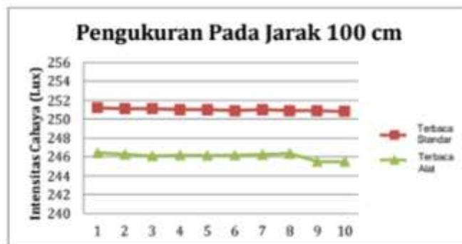
Data yang diperoleh dengan sumber cahaya kolimator yang sama dan posisi Lux Meter standar yang sama dengan posisi alat (jarak 100 cm dari sumber cahaya), terdapat selisih antara hasil pengukuran Lux Meter Standar dengan alat. Selisih pengukuran hasil pengujian yang dilakukan diperoleh nilai persentase error sebesar 0,020 % dan simpangan sebesar -5 Lux.
