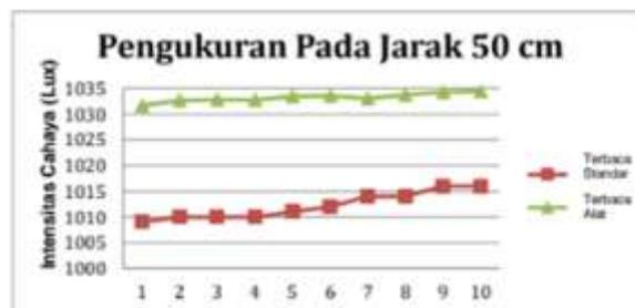
Data yang diperoleh dengan sumber cahaya kolimator yang sama dan posisi Lux Meter standar yang sama dengan posisi alat (jarak 50 cm dari sumber cahaya), terdapat selisih antara hasil pengukuran Lux Meter Standar dengan alat. Selisih pengukuran hasil pengujian yang dilakukan diperoleh nilai persentase error sebesar 0,021 % dan simpangan sebesar -21 Lux.
