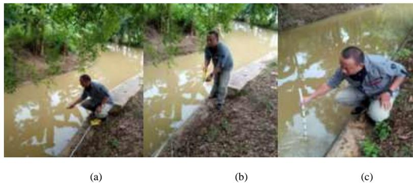
Gambar 1. Pengukuran (a) Kecepatan Rata-rata dan Debit Air, (b) Luas Penampang Saluran, dan (c) Kedalaman Saluran di Lokasi Saluran Primer Pada Jaringan Irigasi D.I Cipicung
