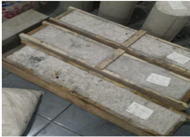
Gambar 3. Dokumentasi 3 Sampel Balok Beton 10x15x60 cm
