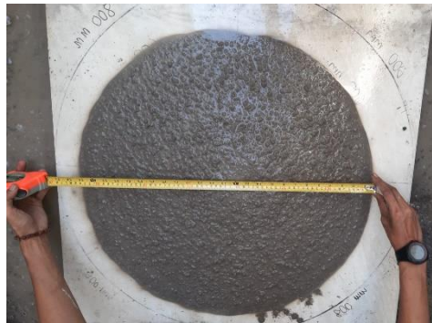
Gambar 3. Pengujian Uji Slump Flow Beton SCC 4% Penambahan Serat Ijuk
