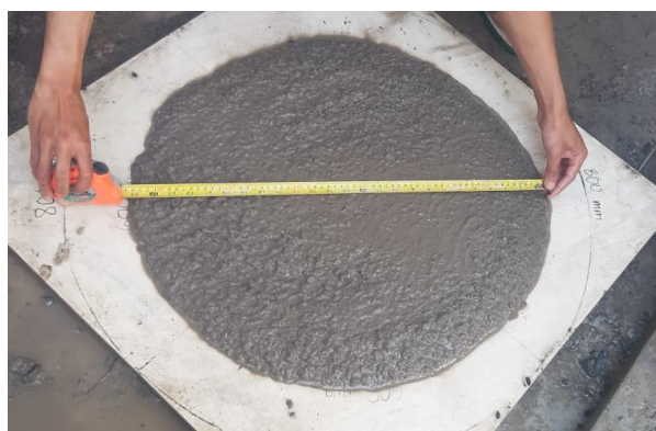
Gambar 2. Pengujian Uji Slump Flow Beton SCC 2% Penambahan Serat Ijuk
