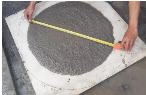
Gambar 4. Pengujian Uji Slump Flow Beton SCC 6% Penambahan Serat Ijuk
