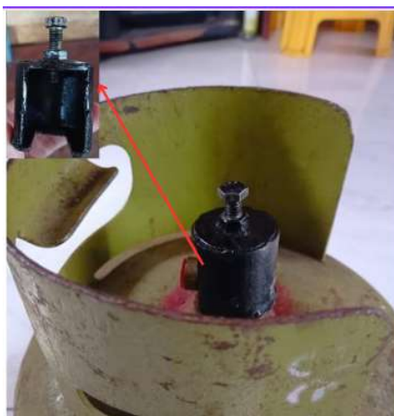
Gambar 7. Alat Tambahan Untuk Membocorkan Tabung Gas 3kg
